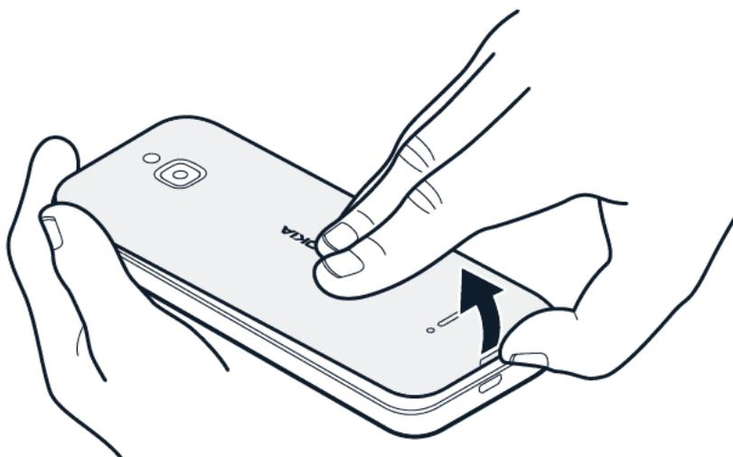
1. Вставьте ноготь в небольшой разъем в нижней части телефона, поднимите и снимите крышку.
