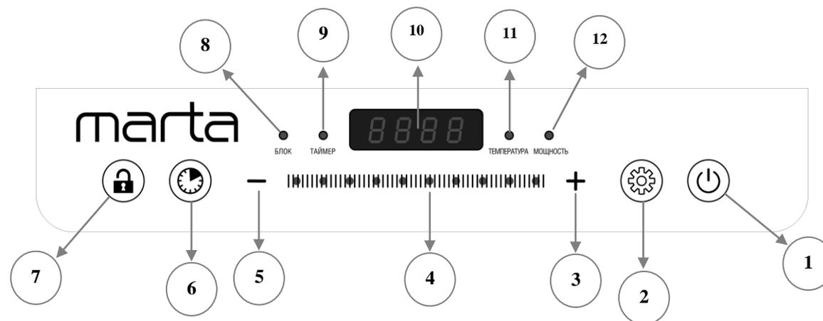
Подключите прибор к сети питания. После звукового сигнала на дисплее загорится OFF, включится вентилятор охлаждения. Устройство готово к работе и находится в режиме ожидания.
